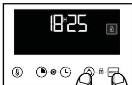
Appuyez simultanément sur les touches et jusqu'à l'affichage du symbole à l'écran. Pour le déverrouiller, appuyez simultanément sur les touches et jusqu'à ce que le symbole disparaisse de l'écran.
