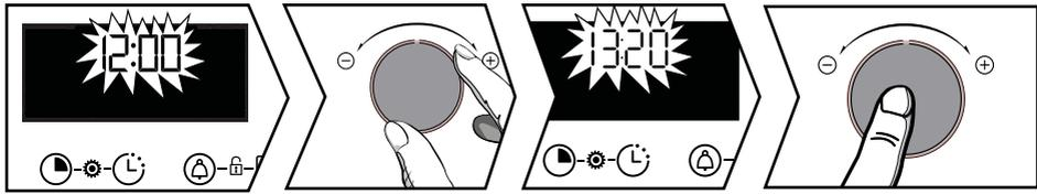
A la mise sous tension l'afficheur clignote à 12:00.
