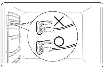
3. Branchez le connecteur de la sonde dans la prise sur le mur du côté gauche. Assurez-vous que le voyant Sonde thermique insérée est allumé lorsque le connecteur de la sonde est branché.
