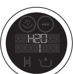
La machine est préconfigurée à l'usine sur le « Niveau d'eau dure - 3 ». Il est possible de programmer la machine selon la réelle dureté de l'eau utilisée, ce qui rend ainsi moins fréquente l'opération de détartrage.
