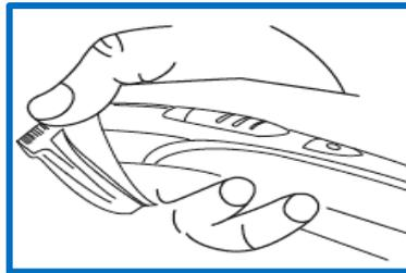
2. Alignez et insérez l'accessoire dans la fente de la base de la tête. Appuyez doucement dessus pour l'enclencher. Vous entendrez un « clic » une fois l'accessoire correctement installé.
