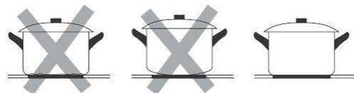
Zorg ervoor dat de diameter van de recipiënten aangepast is aan de diameter van het kookvuur en dat u de recipiënt in het midden van het kookvuur plaatst.
