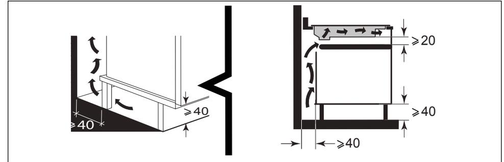
ou au-dessus d'un four encastrable, respectez les dimensions notées sur les illustrations afin d'assurer une sortie d'air suffisante.
