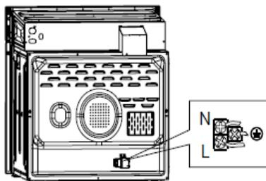
Important: le câble d'alimentation doit être positionné de façon à ce qu'aucun point n'atteigne une température supérieure à 50°C au-delà de celle ambiante.
