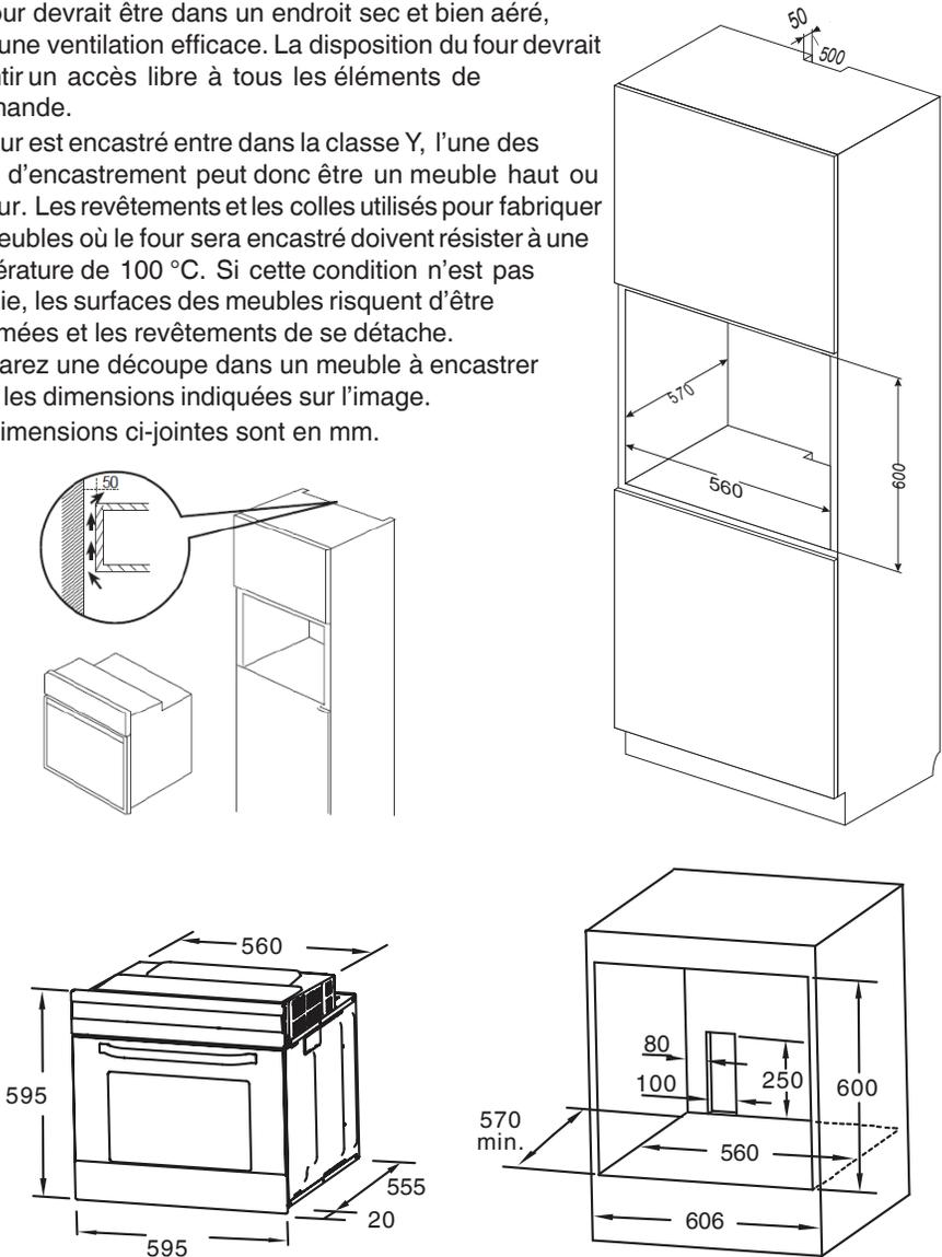
Après avoir encastré le four dans le meuble, ouvrez la porte et fixez latéralement la moulure du four au meuble avec les deux vis (un de chaque côté), dans les trous prévus à cet effet.
