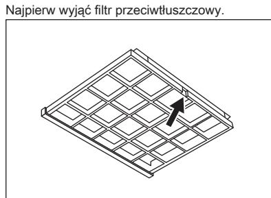
W celu zamontowania filtrów należy wykonać opisane czynności w odwrotnej kolejności.
